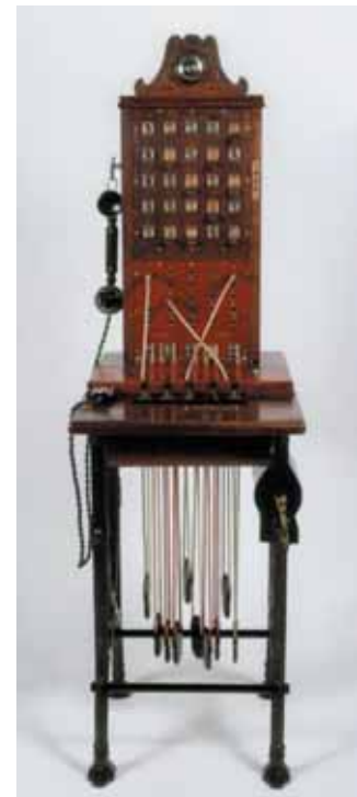
Pequeña centralita con cuadros de jack (contactos de terminación de circuitos) y clavijas de cordón de Ericsson. Suecia 1884
