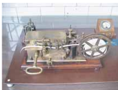
La señal telegráfica morse que llegaba al receptor se hacía pasar por un miliamperímetro además del acústico. La fotografía representa el miliamperímetro y el receptor morse de la oficina de Sitges actualmente en la Sala de Reuniones de Correos de Barcelona
