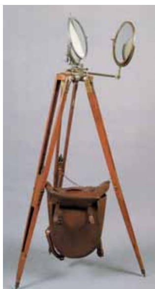
Heliógrafo. En este aparato telegráfico se aprovechan los rayos solares, reflejados en un espejo plano, orientados hacia el puesto receptor, moviéndose el espejo mediante un manipulador con la cadencia de los puntos y las rayas del código morse
