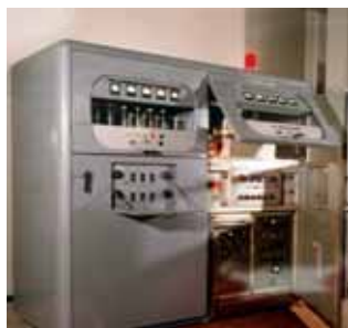
El servicio móvil marítimo acabó con el aislamiento histórico de los navegantes, mejorando definitivamente la seguridad de la vida humana en el mar. La foto corresponde a un transmisor de radio de onda corta utilizado en una estación costera de Telefónica
