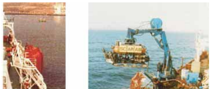
Fotografía de un buque cablero moderno y de un tractor especial (Scarab) del buque cablero usado en 1990 para el tendido de cables submarinos de fibra óptica
