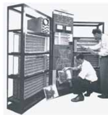
La fotografía muestra el primer ordenador transistorizado fabricado en Estados Unidos; estos ordenadores se llamaron de segunda generación y su ahorro de energía era considerable así como su facilidad de programación como puede verse comparando esta fotografía con la del ENIAC de 1949
