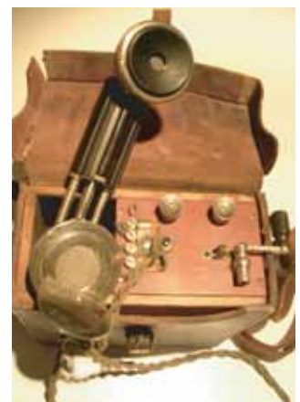
Teléfono de magneto usado por los operarios de las compañías eléctricas en la zona de Castellón. La manivela permitía generar su propia corriente y enviar la señal a la central
