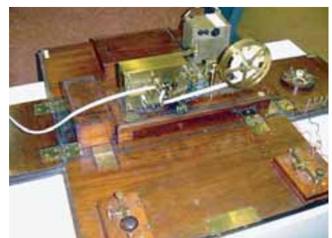
La Guerra Civil española de 1936 obligó al desarrollo de los telégrafos portátiles de campaña, como el de la fotografía que incorpora el manipulador y receptor morse en una caja portable
