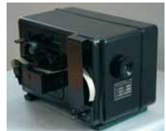
Perforador de cinta morse SIEMENS. Equipo auxiliar de transmisión morse en redes permanentes
