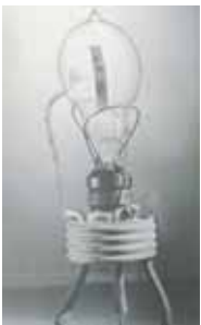
En 1904 Sir Ambrose Fleming inventó el primer prototipo (diodo) de las válvulas de radio de vacío colocando una placa en una lámpara de Edison que servía para detectar las ondas electromagnéticas con más precisión que el cohesor
