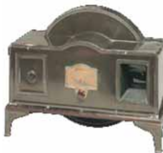
En 1932 la BBC emitió señales de televisión en Londres a 40 líneas y 15 imágenes por segundo por el procedimiento mecánico de Baird y se empezaron a vender los primeros aparatos; en la fotografía primera se ve un equipo receptor y en la segunda una imagen de 40 líneas de color amarillento producida por un descargador de neón
