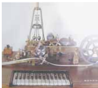
Vista en detalle del teclado del teleimpresor Hughes, con el que el operador transmitía los caracteres del regulador de bolas para estabilizar mecánicamente la velocidad, y de otros mecanismos
