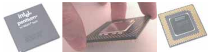
Tres fotografías con vistas desde arriba, de lado y desde abajo del CHIP microprocesador Intel Pentium MMX a 200 Mhz. con 4.500.000 transistores, encapsulado, fabricado en enero de 1997
