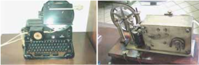
(Izquierda) Perforadoras de Siemens. Las perforadoras se usaron en Telégrafos para automatizar el envío de varios telegramas con el mismo destino. La perforadora sacaba una cinta perforada que se transmitía por el transmisor automático. (Derecha) Fotografía de la parte trasera de un receptor morse de los que todavía se usaban en las zonas rurales de Telégrafos a principios de los años setenta del siglo XX
