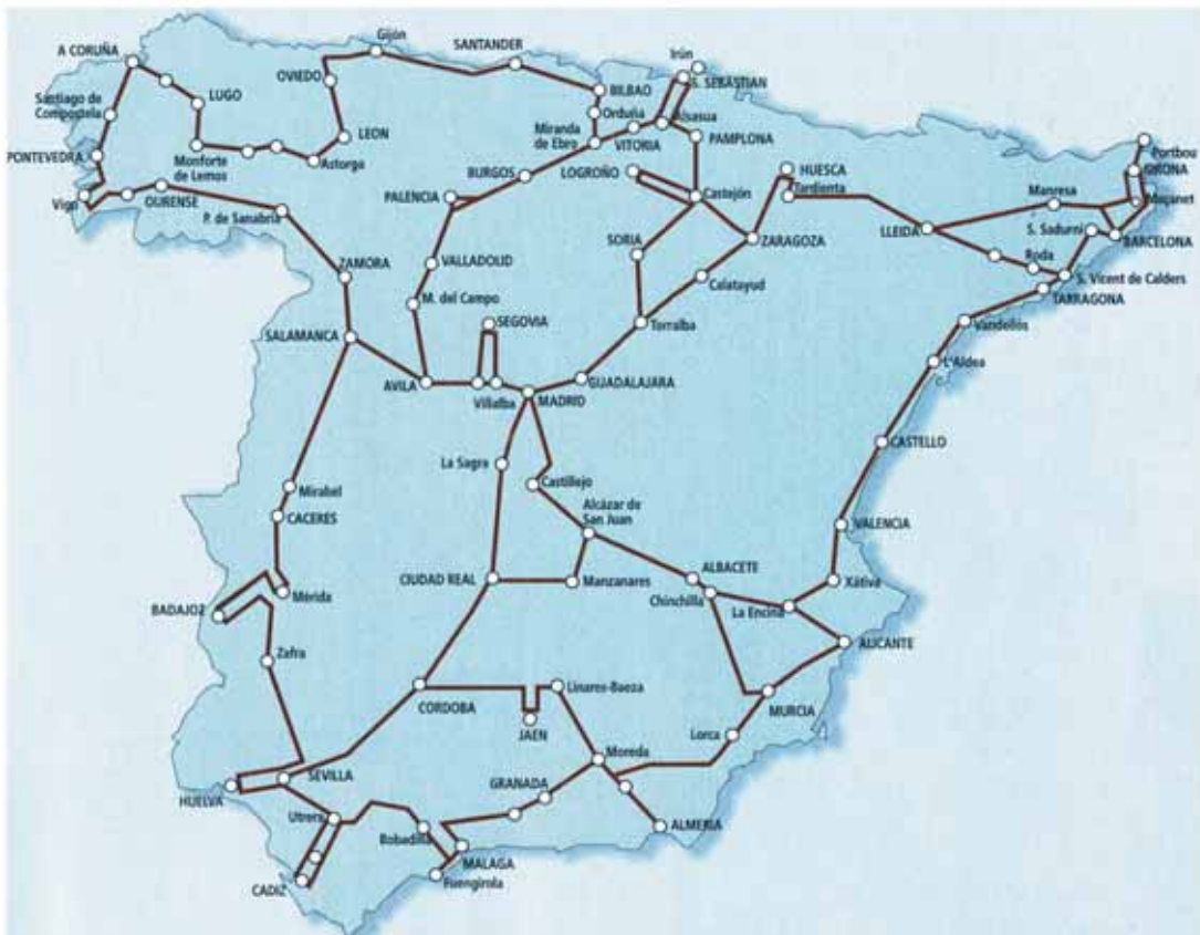
Topología de la red de fibra óptica realizada sobre las líneas de RENFE y de FEVE; esta última se encontraba básicamente entre Gijón y Bilbao
