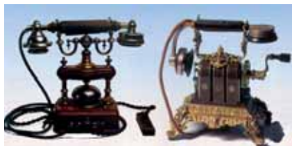
Teléfonos manuales antiguos de lujo de la marca Ericsson que ya presentan unidos el micrófono y el receptor en una sola pieza y en los que puede verse el timbre de llamada y la magneto para llamar
