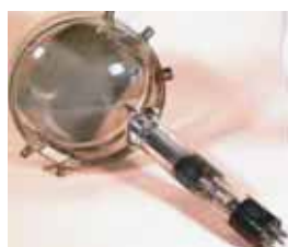
En 1923 Wladimir Zworykin inventó el iconoscopio, dispositivo basado en el tubo de Braun, que escaneaba una imagen mediante un barrido electrónico, fundamento de las cámaras de televisión
