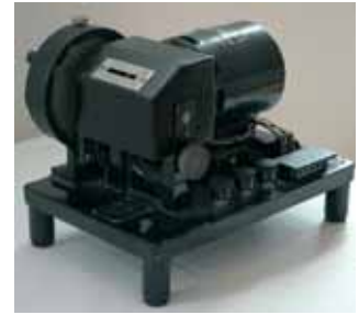
Transmisor de cinta CREED. Aparato auxiliar en redes telegráficas permanentes entre capitánías y mandos del ejército
