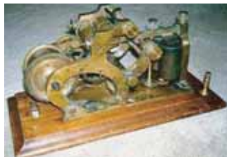
Receptor morse empleado para recibir mediante cinta impresa los impulsos de la telegrafía eléctrica que el operador convertía en letras según el código morse
