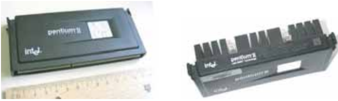
Dos fotografías con vistas desde arriba con una regla para comparación de tamaños y de lado del CHIP microprocesador Intel Pentium II a 300 Mhz. con 7.500.000 transistores, encapsulado, fabricado en mayo de 1997
