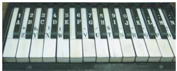
Detalle del teclado de emisión del primer equipo práctico teleimpresor de telegramas en cinta
