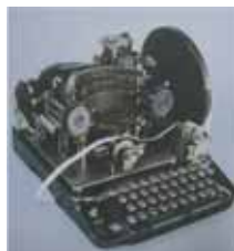
En 1934 se introdujeron en las redes de Telégrafos los teletipos Creed que, con el mismo sistema de funcionamiento, eran más rápidos que los Morkrum
