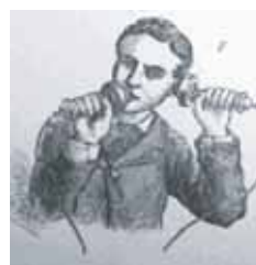
Los primeros teléfonos tenían un micrófono y un receptor independientes siendo necesario usar las dos manos para hablar por él. En 1895 el invento de la bobina híbrida permitió unir los dos en una sola pieza. En la figura de arriba se aprecia un teléfono y en la de la izquierda la forma en que se utilizaba
