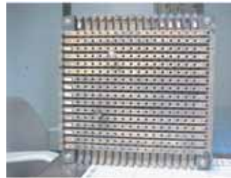
En las estaciones telegráficas con varias líneas empezó a usarse el conmutador de barras cruzadas, llamado suizo, que conectaba mediante una clavija las líneas que entraban por una barra con los equipos telegráficos (manipulador y receptor morse) que entraban por la otra. El conmutador de la fotografía prestó servicio en Vilafranca del Penedés (Barcelona)
