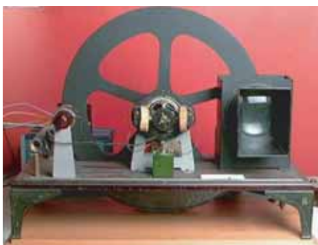
En 1929 Baird empezó a realizar las primeras pruebas con su televisión mecánica utilizando el disco de Nipkow; en la fotografía puede verse el enorme disco y la pequeña pantalla
