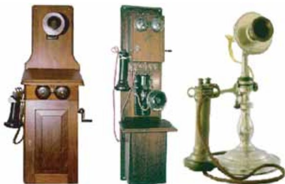
En las fotos pueden verse varios teléfonos antiguos en los que el micrófono y el receptor constituían piezas separadas, si bien se había adaptado la ergonomía para tener que usar sólo una mano poniendo el emisor a la altura de la boca o el receptor a la altura del oído. Puede verse la magneto de llamada a la operadora y el timbre de llamada
