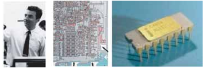
Fotografía de Federico Faggin, ingeniero de Intel, que en 1971 diseñó y fabricó el primer microprocesador de 4 bits en una sola pastilla (chip) con 2.300 transistores llamado Intel 4004; fotografía del microprocesador muy ampliada y fotografía del microprocesador encapsulado. Este invento revolucionó el mundo de los ordenadores
