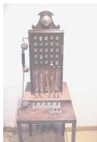
El desarrollo de la telefonía llevó a utilizar centrales manuales en las oficinas que permitían conectar a cualquier abonado que llamase con el llamado mediante una operadora. La central de la derecha prestó servicio en Barcelona
