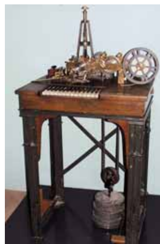
Teleimpresor Hughes, primer equipo que transmitía mediante un teclado e imprimía directamente en cinta los caracteres alfabéticos de los telegramas
