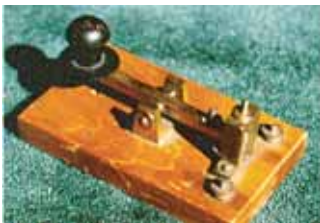
Manipulador morse empleado para transmitir los impulsos de la telegrafía eléctrica codificando el operador las letras según el código morse
