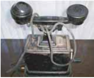
Teléfono de magneto de principios del siglo XX. La corriente de llamada se generaba mediante la actuación de la persona sobre el magneto que incorporaba. Este tipo de teléfono acabó siendo reemplazado por el teléfono de disco que, de acuerdo con la amplitud de giro, generaba una serie de pulsos eléctricos (por cortes de la línea) que a su vez representaban uno de los 10 dígitos, del 0 al 9
