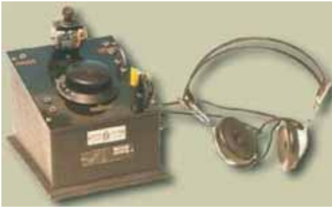
Equipo de radio de detección por galena de 1927 con sus auriculares. Puede verse el botón de sintonía central
