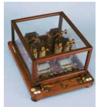
Traslator D'Arlincourt. Es un repetidor telegráfico que permite amplificar (tomando pila local intermedia) las débiles corrientes que se reciben en líneas largas, consiguiendo así alcances mucho mayores. Es simétrico, para utilizarse en ambos sentidos, incluso simultáneamente
