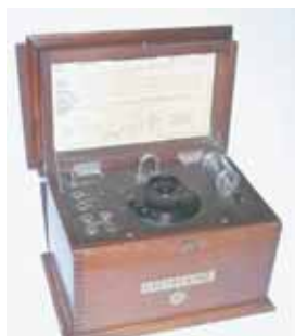
Radio de galena, equipo de 1924 para escuchar la radio mediante auriculares y que no necesitaba alimentación externa; sólo permitía captar las emisoras potentes
