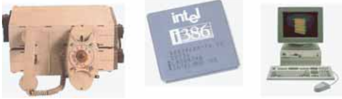
(Izquierda) Primer teléfono móvil para vehículos comercializado por CTNE en España. (Centro) Parte superior del CHIP microprocesador de 32 bit Intel 80386 con 275.000 transistores, encapsulado y fabricado en 1985. (Derecha) Ante el gran éxito obtenido por el IBM PC y sobre todo de sus clónicos, IBM comercializó en abril de 1987 el ordenador personal PS/2 de la fotografía, que usaba patentes y tecnología propietaria. El modelo no prosperó y años después tuvo que volver a fabricar el antiguo PC
