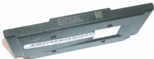
Fotografía del CHIP microprocesador Intel Pentium III a 750 Mhz. encapsulado fabricado en julio de 1999
