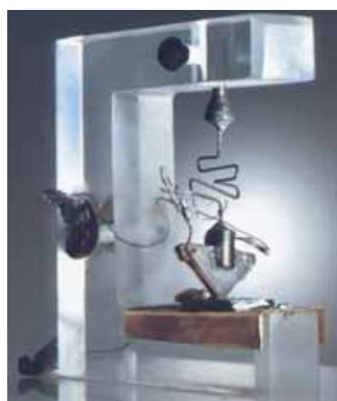
Fotografía muy ampliada del primer transistor de puntas de 1948. Sus descubridores partieron de diodo de punta de contacto y tras muchos experimentos consiguieron un dispositivo de cristal que, con dos puntas de contacto muy próximas, podía amplificar consumiendo mucha menos energía que los tubos de vacío. El transistor revolucionó todos los dispositivos electrónicos
