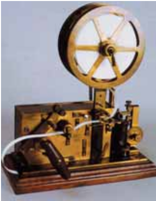
Receptor impresor Morse. El electroimán receptor (derecha) lleva unida a la armadura móvil la pluma (rueda entintada) que imprime sobre la cinta de papel los puntos y rayas del mensaje que se recibe. Un mecanismo de relojería arrastra la cinta con velocidad uniforme
