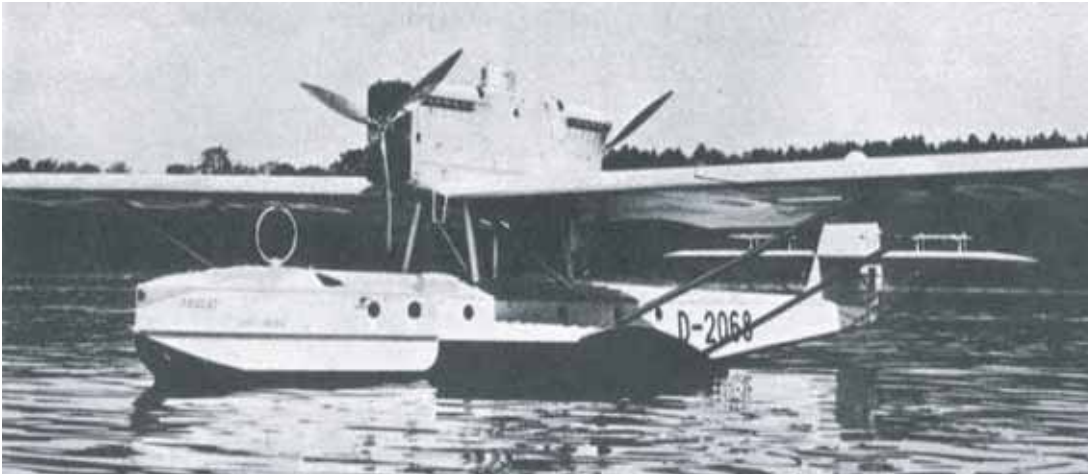
Los equipos de radiocomunicaciones comienzan a ser vitales para el desarrollo de las grandes líneas aéreas de correo y pasaje. Imagen de un hidroavión Dornier «Wal» similar al Plus Ultra que realizó el primer salto del Atlántico Sur en 1926. Obsérvese la antena de cuadro del morro radiogoniómetro cerca del morro
