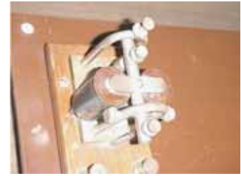
La señal telegráfica morse que llegaba al receptor se hacía pasar por un electroimán que accionaba una armadura solidaria de un tubo hueco que golpeaba un tornillo produciendo un ruido característico en los puntos y rayas que permitía a un operador experimentado la recepción a oído. El acústico de la fotografía prestó servicio en Barcelona
