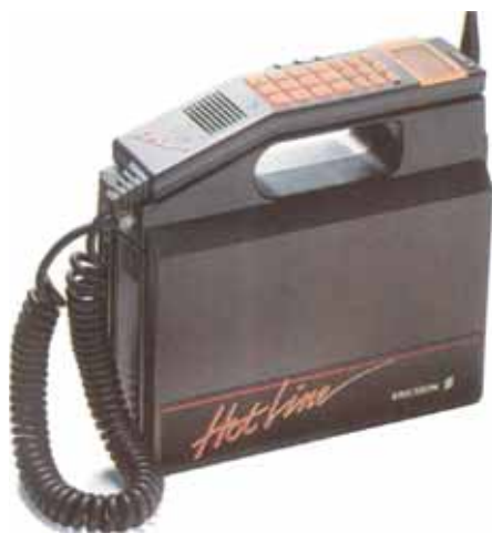
Figura 2. Teléfono móvil Hotline 450 Combi de Ericsson para redes NMT-450, 1986. Para el servicio TMA se desarrollaron terminales de usuarios que se llevaban cogidos con un asa a modo de maletín, lo que permitía su portabilidad fuera de los vehículos
