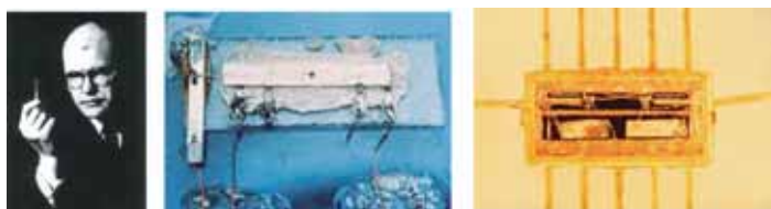
El 12 de septiembre de 1958 el norteamericano Jack Kilby, que puede verse en la primera fotografía, acabó de comprobar el primer circuito integrado (microchip) que había diseñado y construido y que puede verse en las otras dos fotografías. Este invento revolucionó todos los dispositivos electrónicos, en especial los ordenadores
