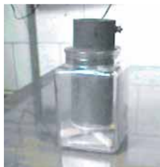
La señal telegráfica necesitaba de pilas en sus comienzos para su funcionamiento. Una de las más utilizadas fue la pila Fery de la fotografía, con ánodo de carbón y cátodo de zinc sumergido en una disolución de cloruro amónico. La pila de la fotografía prestó servicio en Girona
