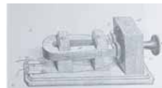
Bell inventó en 1876 un nuevo sistema de comunicación que reproducía a distancia la voz de una persona que hablaba, el teléfono, del que puede verse la parte receptora en la imagen
