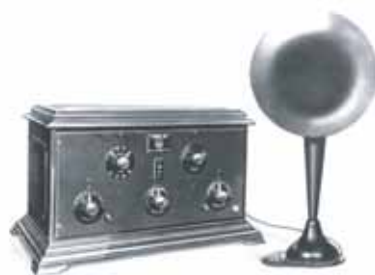
Radio superheterodino, equipo de 1924 con alimentación externa y amplificación mediante tubos de vacío y con un electro parlante (altavoz) en forma de bocina que permitía la captación de emisoras distantes
