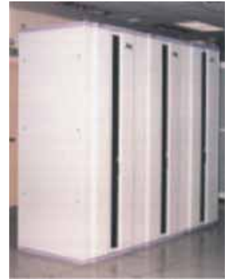
Equipo Tesys-B. En 1978, Telefónica inició el proyecto de construcción de unos conmutadores de paquetes, a los que denominaría equipos TESYS, y que por sus prestaciones los situaban a la cabeza de este tipo de sistemas. A la primera familia TESYS A, le seguirían los TESYS B, calificados por Telefónica en 1990 como nodos de tránsito para la red de paquetes IBERPAC
