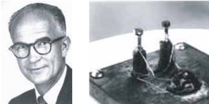
Fotografía de Shockley y del primer transistor de unión de 1949. El transistor de unión podía fabricarse en serie y mucho más fácilmente que el transistor de puntas
